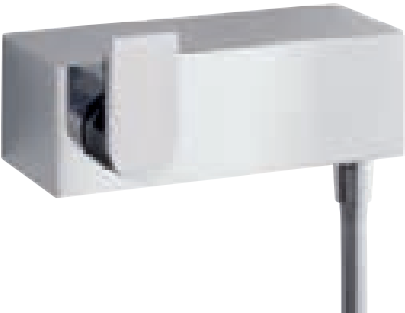
53024 Páková sprchová směšovací armatura pro nástěnnou montáž keramická kartuše s teplotní zářázkou, napojení hadice DN 15, rozteč 150 +/- 14 mm šířka: 210 mm vyložení: 116 mm
