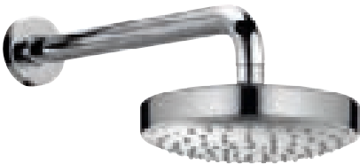
51683 Hlavová sprcha s napojením na stěnu DN 15 Ø 180 mm, se sprchovým ramenem průtokové množství omezeno na 10 l/min. vyložení: 300, 450 mm
