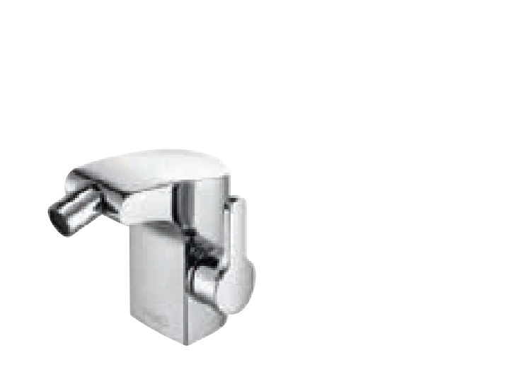
51609 Páková bidetová směšovací armatura s odtokovou soupravou s táhlem 1 ¼ coulu, 1otvorová montáž, směšovací kartuše s keramickými těsnicími kroužky výška: 112 mm vyložení: 126 mm
