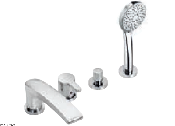
51630 Páková vanová a sprchová směšovací armatura 4otvorová montáž na okraji vany, směšovací kartuše s keramickými těsnicími kroužky, s automatickým vracením do polohy vana/sprcha, zápustná ruční sprcha s normálním, jemným a masážním proudem (vhodný montážní blok objednejte prosím zvlášť) výška: 124 mm vyložení: 239 mm
