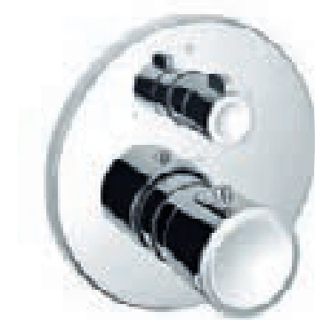
54074 Termostatická baterie pro montáž pod omítku, s keramickým uzavíracím a přepínacím ventilem, vrchní sada vhodná pro Flexx Boxx THM DN 20, součásti: úchyt, objímka a růžice (Flexx Boxx EHM DN 20 objednejte prosím zvlášť)
