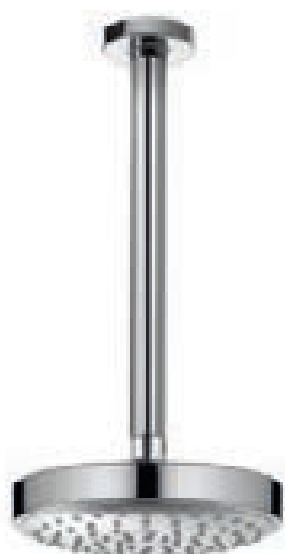
51684 Hlavová sprcha s napojením na strop DN 15 Ø 180 mm, se sprchovým ramenem průtokové množství omezeno na 10 l/min. vyložení: 100, 300 mm
