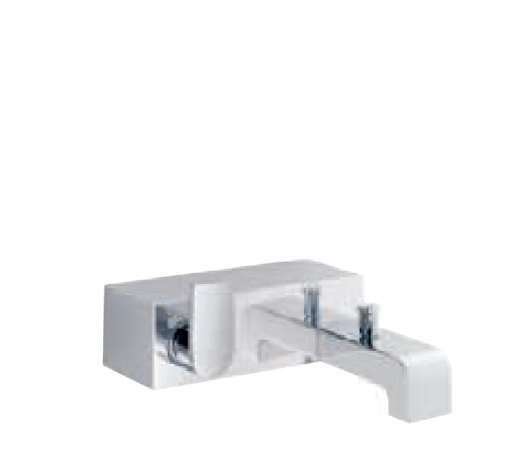
53020 Páková vanová směšovací armatura pro nástěnnou montáž keramická kartuše s teplotní zářázkou, s automatickým vrácením do polohy vana/sprcha rozteč 150 +/- 14 mm šířka: 210 mm vyložení: 205 mm
