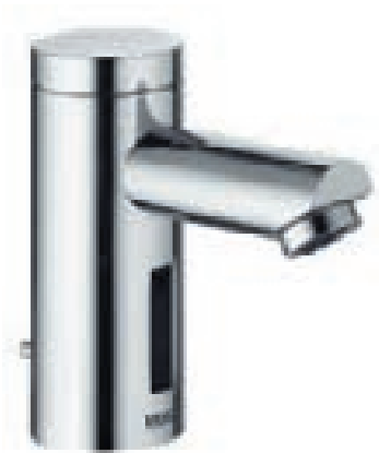
54911 Senzorová umyvadlová armatura s odtokovou soupravou s táhlem/bez soupravy, 1otvorová montáž, modulární monoblok bez podstavce, infračervená senzorika (automatické nastavení), nastavitelná doba doběhu (baterie 6 voltů lithium DL 223 A) výška: 132 mm vyložení: 139 mm
