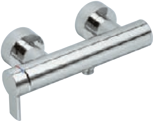
54924 Páková sprchová směšovací armatura pro nástěnnou montáž keramická kartuše s teplotní zarážkou, napojení hadice DN 15, rozteč 150 +/- 14 mm šířka: 282 mm vyložení: 115 mm
