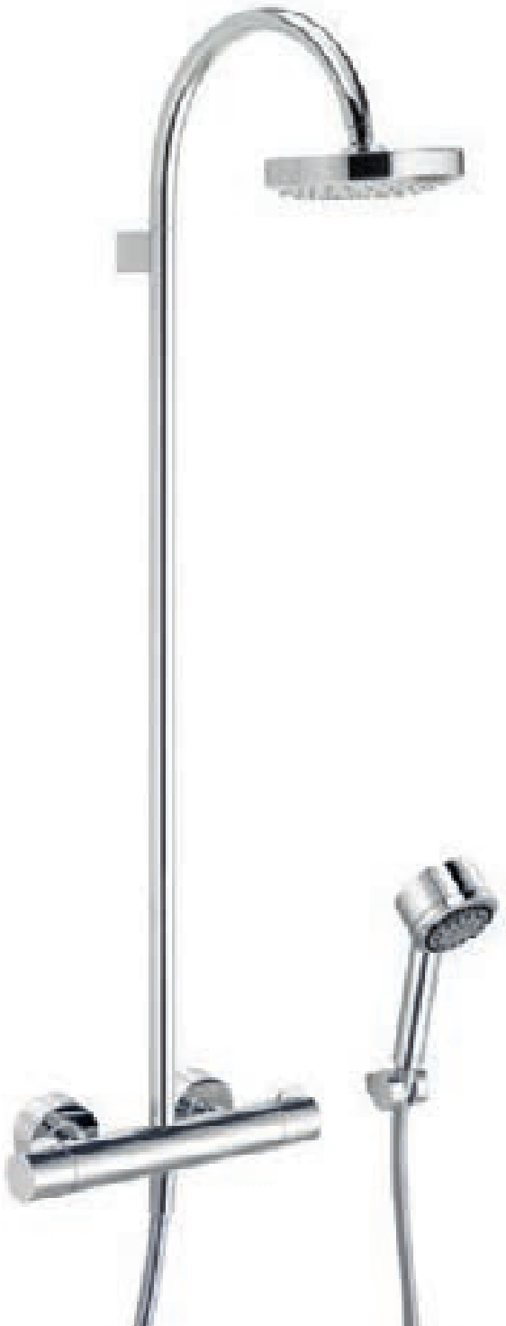
53924 Sprchová směšovací armatura s hlavovou sprchou pro nástěnnou montáž, keramický uzavírací a přepínací ventil, směšovací ventil s keramickými těsnicími kroužky, hlavová sprcha výkyvná, Ø 180 mm, průtokové množství omezeno na 9 l/min, ruční sprcha s normálním, jemným a masážním proudem, s posunovačem sprchy, držákem sprchy a sprchovou hadicí (1600 mm), napojení hadice DN 15, rozteč 150 +/-14 mm šířka: 310 mm výška: 1192 mm vyložení: 104 mm
