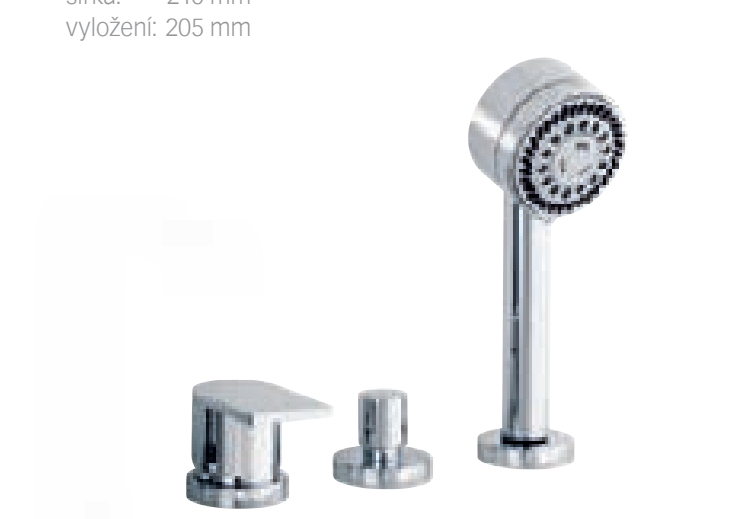
53030 Páková vanová a sprchová směšovací armatura 3otvorová montáž na okraji vany, směšovací kartuše s keramickými těsnicími kroužky, s automatickým vracením do polohy vana/sprcha, zápusťná ruční sprcha s normálním, jemným a masážním proudem (vhodný montážní blok objednejte prosím zvlášť)
