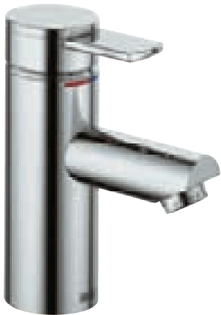
54904 Páková umyvadlová směšovací armatura středně velké provedení, bez odtokové soupravy s táhlem, 1otvorová montáž, keramická kartuše s teplotní zarážkou výška: 145 mm vyložení: 120 mm
