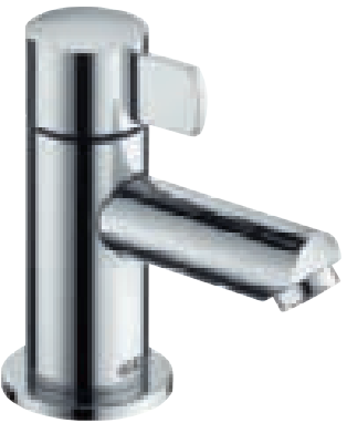
54908 Stojánkový ventil bez odtokové soupravy s táhlem, 1otvorová montáž, 90° vrchní díl s keramickými těsnicemi kroužky výška: 115 mm vyložení: 105 mm
