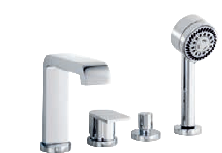
53030 Páková vanová a sprchová směšovací armatura 4otvorová montáž na okraji vany, směšovací kartuše s keramickými těsnicími kroužky, s automatickým vracením do polohy vana/sprcha, zápusťná ruční sprcha s normálním, jemným a masážním proudem (vhodný montážní blok objednejte prosím zvlášť) výška: 184 mm vyložení: 201 mm
