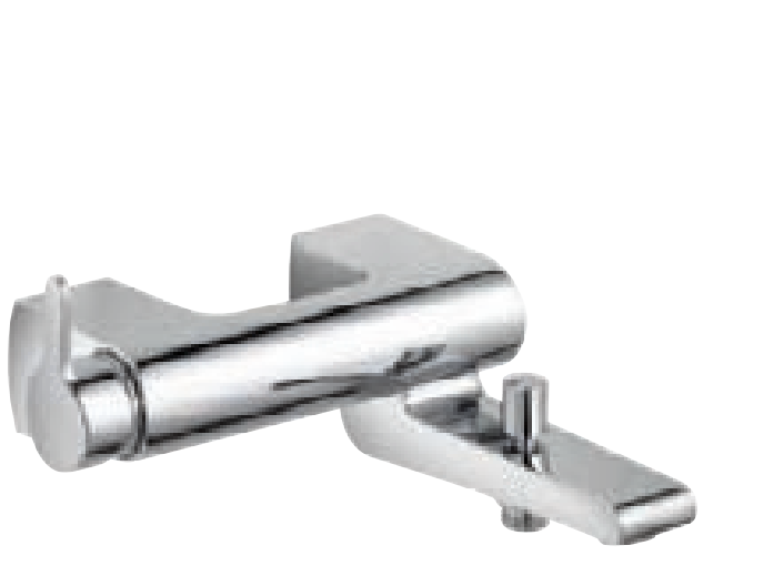
51620 Páková vanová směšovací armatura pro montáž na zeď, směšovací kartuše s keramickými těsnicími kroužky, s automatickým vracením do polohy vana/sprcha, napojení hadice DN 15, rozteč 150 +/- 14 mm šířka: 245 mm vyložení: 220 mm
