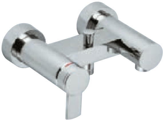
54920 Páková vanová směšovací armatura pro nástěnnou montáž keramická kartuše s teplotní zarážkou, s automatickým vrácením do polohy vana/sprcha napojení hadice DN 15, rozteč 150 +/- 14 mm šířka: 200 mm vyložení: 169 mm
