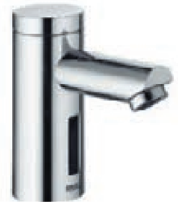
54912 Senzorová umyvadlová armatura bez odtokové soupravy s táhlem, 1otvorová montáž, modulární monoblok bez podstavce, infračervená sensorika (automatické nastavení), nastavitelná doba doběhu (napájení ze sítě 230 V) výška: 132 mm vyložení: 139 mm
