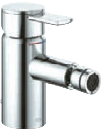
54909 Páková bidetová směšovací armatura s odtokovou soupravou s táhlem, 1otvorová montáž, keramická kartuše s teplotní zarážkou výška: 135 mm vyložení: 137 mm
