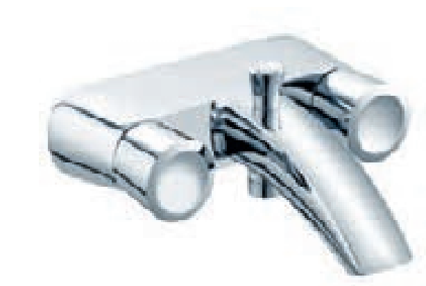
54022 Dvoukohoutková vanová armatura pro nástěnnou montáž, 90° vrchní části s keramickými těsnicími kroužky, s automatickým vrácením do polohy vana/sprcha, napojení hadice DN 15, rozteč 150 +/- 14 mm šířka: 201 mm vyložení: 214 mm
