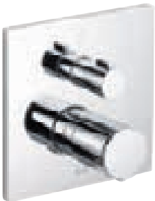
51174 Termostatická armatura pro montáž pod omítku s keramickým uzavíracím a přepínacím ventilem, bezpečnostní zarážka na 38 °C, vrchní sada vhodná pro Flexx Boxx THM DN 20, součásti: úchyt, objímka a růžice (Flexx Boxx THM DN 20 objednejte prosím zvlášť)
