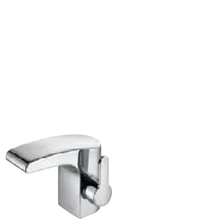
51608 Stojánkový ventil bez odtokové soupravy s táhlem, 1otvorová montáž, 90° vrchní díl s keramickými těsnicími kroužky průtokové množství omezeno na 7,3 l/min. výška: 114 mm vyložení: 139 mm
