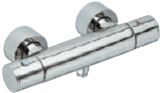
54926 Termostatická baterie pro sprchu pro nástěnnou montáž, úchyt s 50% omezením průtočného množství, bezpečnostní zarážka na 38 °C zabezpečeno proti zpětnému toku napojení hadice DN 15, rozteč 150 +/- 14 mm šířka: 300 mm vyložení: 107 mm
