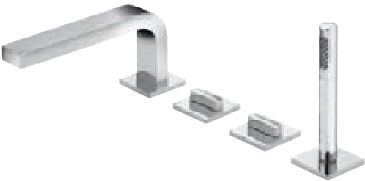
51130 Páková vanová a sprchová směšovací armatura 4otvorová montáž na okraj vany keramický ventil pro nastavení teploty a ventil pro regulaci množství, perlátor M 28 x 1 výsuvná tyčová ruční sprcha zabezpečeno proti zpětnému toku vyložení 180, 220 mm (vhodný montážní blok obj. číslo 51130 objednejte prosím zvlášť)
