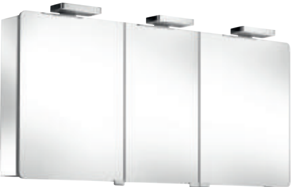
Zrcadlová skříňka 3 otočná dvířka osvětlení: halogenové osvětlení (6 x 20 W) korpus: hliník, stříbrně mořeno eloxováno vybavení: • zadní stěna se zrcadlem • boky se zrcadlem • 1 vnější vypínač • 2 vnitřní elektrické zásuvky • 6 výškově nastavitelných poliček • na přání 2 vnitřní zásuvky rozměry (š x v x h): 1300 x 670 x 169 mm
