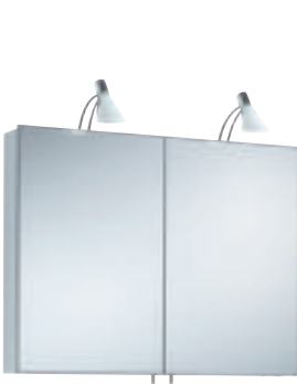
ROYAL PLUS 2 otočná dvířka osvětlení: • halogenové osvětlení (2 x 20 W) korpus: hliník, stříbrně mořeno eloxováno vybavení: • strany se zrcadlem • 1 vypínač • 2 elektrické zásuvky • 2 x 2 výškově nastavitelné poličky rozměry (š x v x h): 800 x 710 x 143 mm
