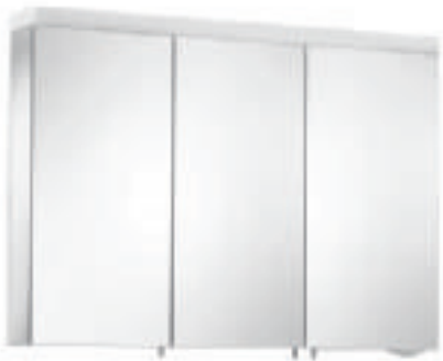
Zrcadlová skříňka 3 otočná dvířka z dvojitého křišťálového zrcadla, po stranách zrcadla panty vlevo nebo vpravo osvětlení: • osvětlení zářivkami (1 x 39 W T5 Seamless) Korpus: stříbrně mořeno eloxováno Vnitřní vybavení: • 1 vnější vypínač • 2 vnitřní elektrické zásuvky • 6 výškově nastavitelné skleněné poličky rozměry (š x v x h): 1000 x 700 x 150 mm
