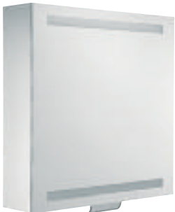
Zrcadlová skříňka 1 výklopná dvířka korpus: hliník, stříbrně mořeno eloxováno osvětlení: • zářivky (2 x 14 W T5) vybavení: • strany se zrcadlem • 1 vypínač (vnější) • 2 vnitřní elektrické zásuvky • 1 vnější elektrická zásuvka • 1 nastavitelné vnitřní zrcadlo (200 x 520 mm) • 5 variabilně nastavitelných skleněných poliček rozměry (š x v x h): 650 x 650 x 160 mm
