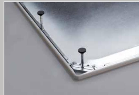
Das **BETTEFUSS-SYSTEM** garantiert den schnellen, sicheren und kostengünstigen Höhenausgleich beim Einbau von Duschwannen und Duschflächen. Hierzu wird ein Rahmen unter dem Wannensrand verspannt, in den die höhenverstellbaren Füße eingeschraubt werden.
